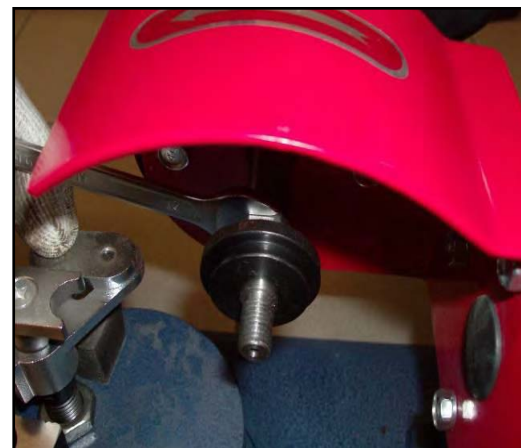
Figura 20 - Rimozione della mola.
