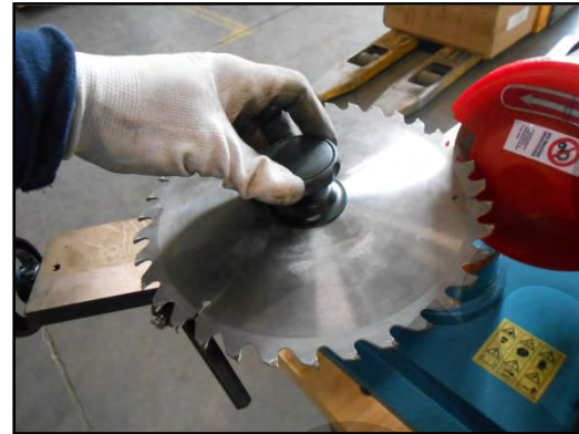
Figura 9 - Montaggio del disco.
