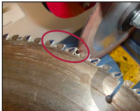
Figura 13 - Marcatura dei denti di sega.
