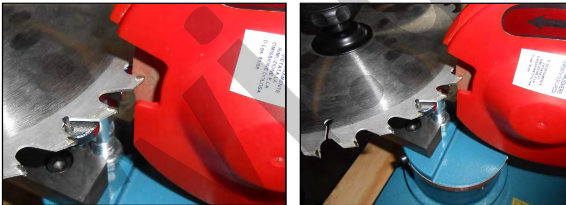
Figura 12 - Regolazione del supporto di riscontro.
