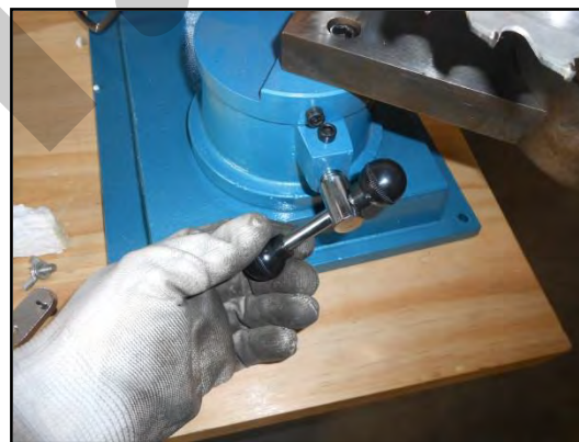
Figura 10 - Regolazione e blocco del supporto girevole.
