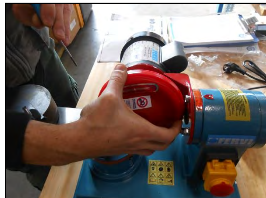
Figura 17 – Rimozione del carter di protezione della mola.
