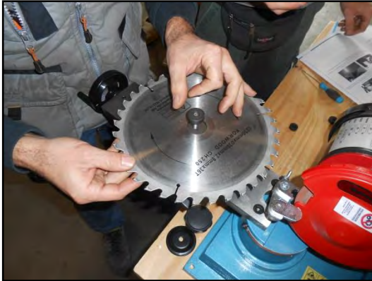
Figura 9 - Montaggio del disco.
