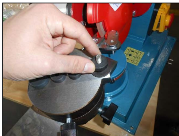
Figura 8 – Montaggio della boccia.
