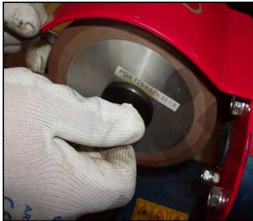
Figura 19 - Rimozione del dado e della flangia.
